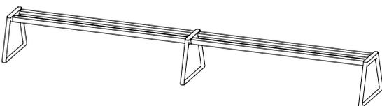
Marco estructural con 3 patas para banco de 6 plazas. El marco está fabricado con 4 perfiles de aluminio extruido de alta resistencia y las patas están fabricadas con aluminio inyectado.
