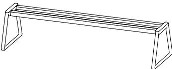
Marco estructural con patas para banco de 3 plazas. El marco está fabricado con 2 perfiles de aluminio extruido de alta resistencia y las patas están fabricadas con aluminio inyectado.
