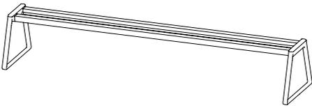
Marco estructural con patas para banco de 4 plazas. El marco está fabricado con 2 perfiles de aluminio extruido de alta resistencia y las patas están fabricadas con aluminio inyectado.
