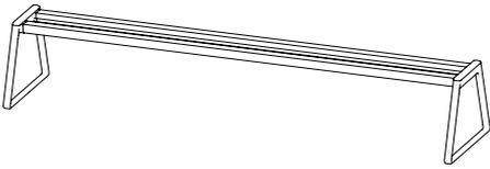
Cadre structurel avec pieds pour banquette de 4 places. Le cadre est constitué de 2 profilés en aluminium extrudé à haute résistance et les pieds sont en aluminium injecté sous pression.
