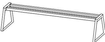
Cadre structurel avec pieds pour banquette de 3 places. Le cadre est constitué de 2 profilés en aluminium extrudé à haute résistance et les pieds sont en aluminium injecté sous pression.
