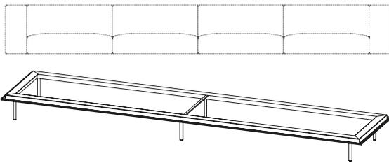
Strukturelles Sofagestell aus stranggepresstem Aluminiumprofil mit 6 Beinen aus Stahlstange. Die Beine können in verschiedenen Positionen montiert werden.
