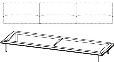
Strukturelles Sofagestell aus stranggepresstem Aluminiumprofil mit 4 Beinen aus Stahlstange. Die Beine können in verschiedenen Positionen montiert werden.
