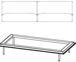
Strukturelles Sofagestell aus stranggepresstem Aluminiumprofil mit 4 Beinen aus Stahlstange. Die Beine können in verschiedenen Positionen montiert werden.
