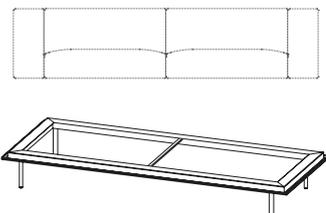
Strukturelles Sofagestell aus stranggepresstem Aluminiumprofil mit 4 Beinen aus Stahlstange. Die Beine können in verschiedenen Positionen montiert werden.
