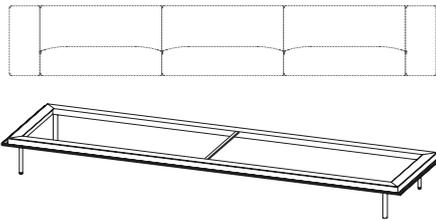
Strukturelles Sofagestell aus stranggepresstem Aluminiumprofil mit 4 Beinen aus Stahlstange. Die Beine können in verschiedenen Positionen montiert werden.
