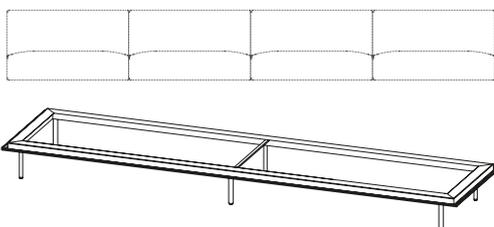
Strukturelles Sofagestell aus stranggepresstem Aluminiumprofil mit 6 Beinen aus Stahlstange. Die Beine können in verschiedenen Positionen montiert werden.
