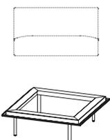
Strukturelles Sofagestell aus stranggepresstem Aluminiumprofil mit 4 Beinen aus Stahlstange. Die Beine können in verschiedenen Positionen montiert werden.
