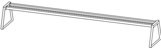
Struktureller Rahmen mit Beinen für eine 5-Sitzer-Bank. Der Rahmen besteht aus 2 hochwiderstandsfähigen, stranggepressten Aluminiumträgern mit speziellem Querschnitt. Die Beine für die Bankenden sind aus einer Aluminiumgusslegierung hergestellt.
