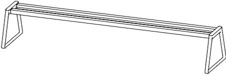
Struktureller Rahmen mit Beinen für eine 4-Sitzer-Bank. Der Rahmen besteht aus 2 hochwiderstandsfähigen, stranggepressten Aluminiumträgern mit speziellem Querschnitt. Die Beine für die Bankenden sind aus einer Aluminiumgusslegierung hergestellt.
