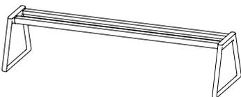
Struktureller Rahmen mit Beinen für eine 3-Sitzer-Bank. Der Rahmen besteht aus 2 hochwiderstandsfähigen, stranggepressten Aluminiumträgern mit speziellem Querschnitt. Die Beine für die Bankenden sind aus einer Aluminiumgusslegierung hergestellt.
