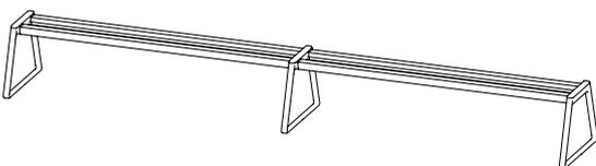
Struktureller Rahmen mit Beinen für eine 6-Sitzer-Bank. Der Rahmen besteht aus 2 hochwiderstandsfähigen, stranggepressten Aluminiumträgern mit speziellem Querschnitt. Die Beine für die Bankenden sind aus einer Aluminiumgusslegierung hergestellt.
